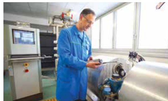
Vodomere pred vgradnjo servisiramo in kontroliramo v lastnem akreditiranem laboratoriju. (fotografija desno)
